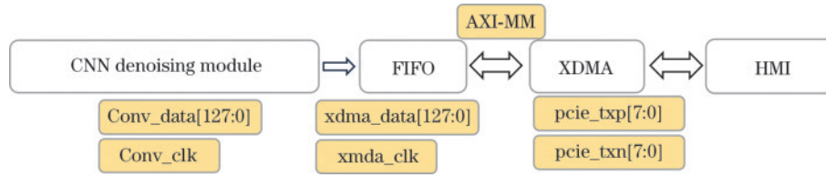
图 7 PCIE 数据传输模块结构 Fig. 7 Structure of PCIE data transmission module
